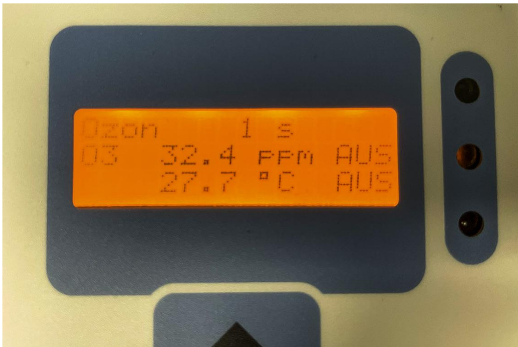
Abb. 4. Display-Anzeige 1 s vor Ende der Ozonbehandlung
