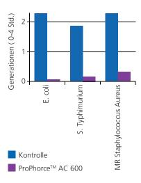
Antibakterieller Effekt von ProPhorce™ AC 600, gezeigt in unabhängigen Versuchen bei pH-Wert 6. ( CCL, 2009 und 2010 )
