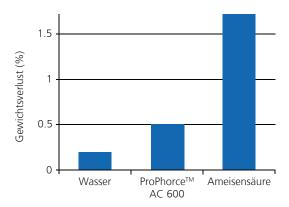
Korrosivität von ProPhorce™ AC 600 auf in die Flüssigkeit eingetauchte Stahlstreifen, gemessen als Gewichtsverlust. Dieser Versuch zeigt, dass ProPhorce™ AC 600 erheblich weniger korrosiv als Ameisensäure und daher sicherer beim Einsatz ist. Es ist sicherer für Ausrüstung und Maschinen, sowie für das einsetzende Personal. (PRW 0783)
