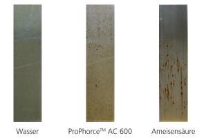
Korrosivität auf in die Flüssigkeit eingetauchte Stahlstreifen, gemessen als Gewichtsverlust.
